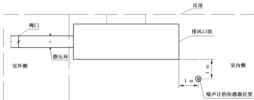
图 G.4 吊顶卧式明装机组
